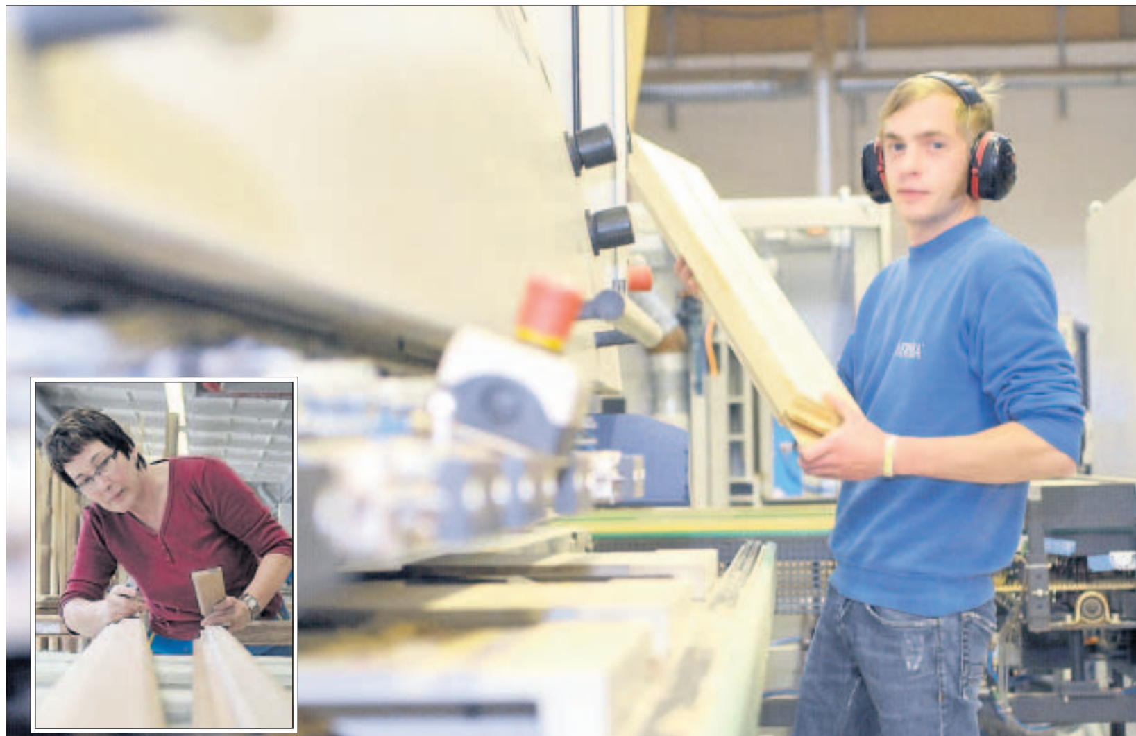
Mitarbeiter André Nitsche arbeitet an der UC-Matic Fensterfertigungsanlage mit Einzelteilfertigung. Hier läuft fast alles hoch technologisiert ab. Aber auch Handarbeit ist noch gefragt: Monika Görllt (kl. Foto) kontrolliert die Fenster und verschmiert Stöße und Löcher mit Holzleim.
