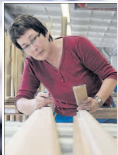
Mitarbeiter André Nitsche arbeitet an der UC-Matic Fensterfertigungsanlage mit Einzelteilfertigung. Hier läuft fast alles hoch technologisiert ab. Aber auch Handarbeit ist noch gefragt: Monika Görllt (kl. Foto) kontrolliert die Fenster und verschmiert Stöße und Löcher mit Holzleim.
